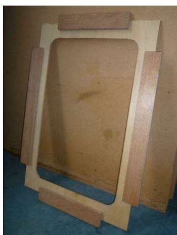
Afb. 18 Gebruik van een mal voor de maatvoering van de raveelconstructie voor een dakraam.
